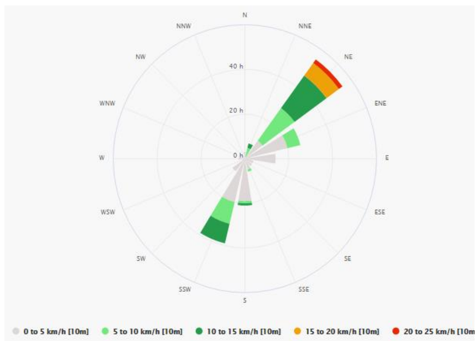
Gráfico 02: Rosa de los vientos promedio en la ciudad de Huánuco a una altura de 10 metros.
